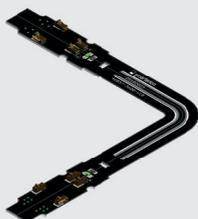
luxKIT elektrischer Verbinder flexibel zur beliebigen Verbindung von 2 luxKIT-Profilen (beliebiger Winkel möglich  $\geq 0-360^\circ$ ), max. 4,2A/50V, grüne LED für 48-V-Spannungskontrolle
